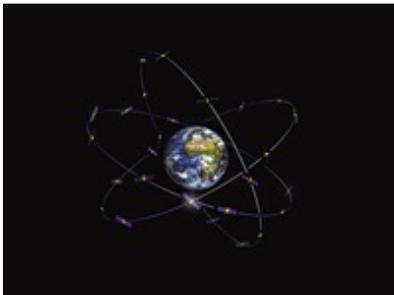
Im vollständigen Zustand soll das Satellitensystem Galileo aus 30 Satelliten, welche gleichmäßig auf drei sich kreuzenden Bahnebenen verteilt sind, bestehen. Die im Orbit befindlichen Satelliten sind in einer ungefähren Höhe von 24.000 km über der Erdoberfläche und werden durch rotierende Solarpaneele ständig mit Energie versorgt. Außerdem verfügt das Galileo-System über ein dichtes Netz an Bodenstationen, welche die Satelliten kontrollieren.
