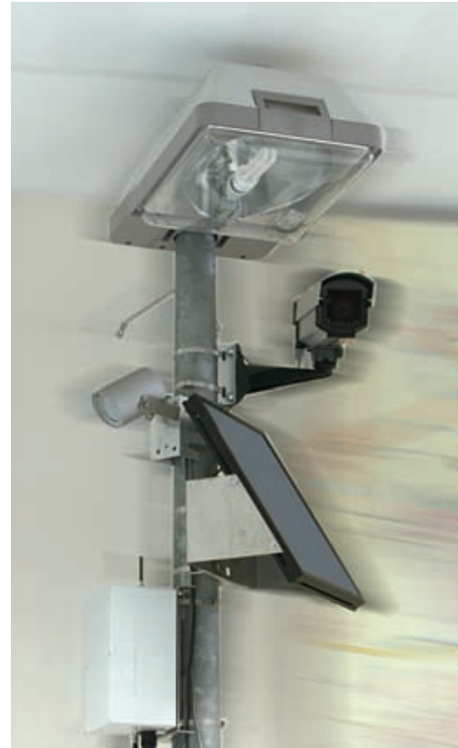
Abb. 19: Innovation durch Integration: Mit Hilfe dieses Funkkamerasystems zur Verkehrsüberwachung kann bereits bestehendeameratechnik in innovative Systeme eingebettet werden.
