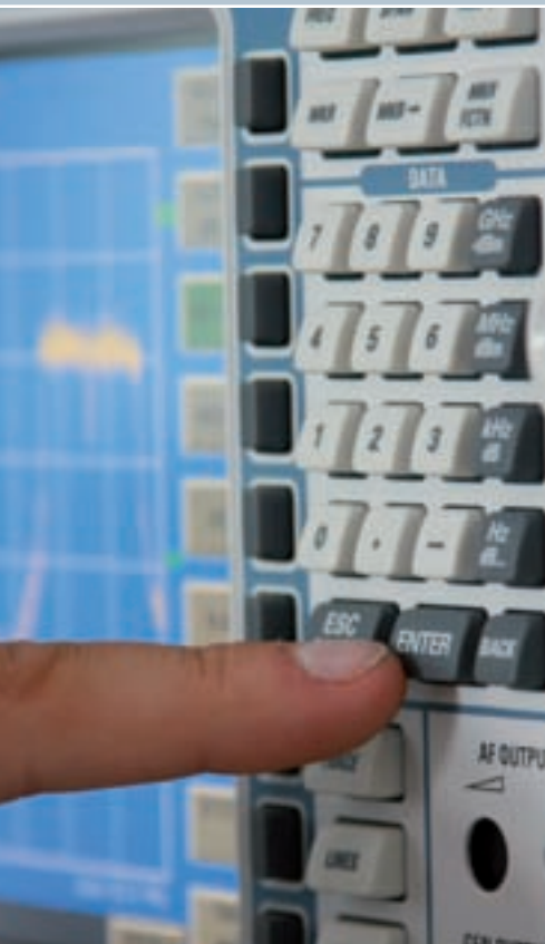
Abb. 32: Sieht unscheinbar aus, liefert aber hochwertige Informationen: Der Spectrumanalyzer.
