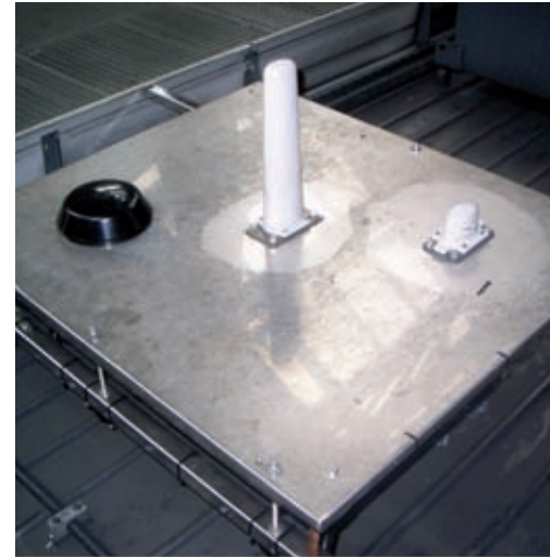
Abb. 20: Sende- und Empfangseinheiten auf der Straßenbahn der HAVAG im MOSAIQUE-Testfeld Halle (Saale).
