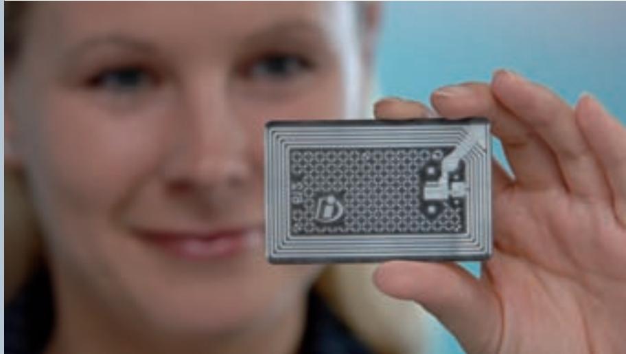
Abb. 18: RFID-Label – Informationsträger modernster Logistik.
